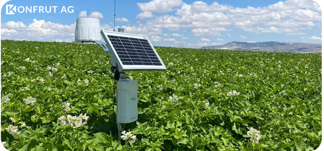
Görsel: Üreticilerin sulamalarını doğru zamanda doğru miktar ile yönetebilmelerini sağlayan yapay zeka tabanlı bir sulama optimizasyon IoT çözümü
